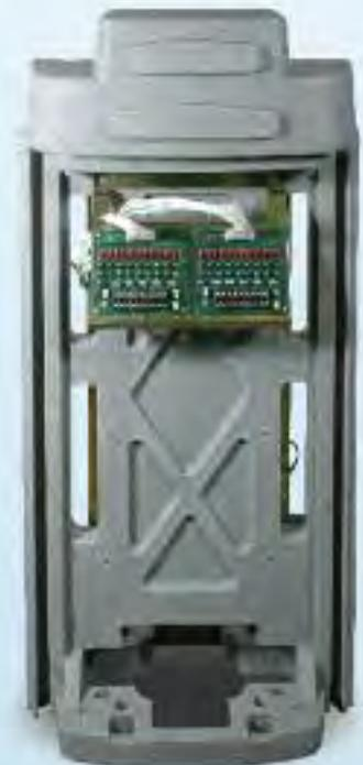
Piédestal plastique en vue dos (Représentant les connexions pour le câblage des voies)
