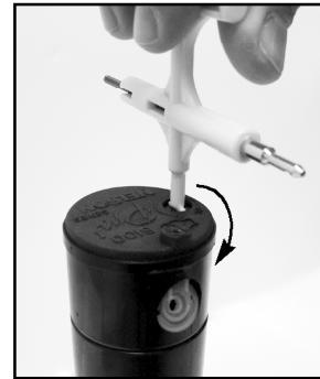
**DIMINUZIONE DELL'ARCO:** Verificare che la torretta dell'ugello sia in corrispondenza del punto fisso a destra e inserire l'estremità piatta della chiavetta nella fessura di regolazione dell'arco. Quindi, ruotare la chiavetta in senso antiorario. Ogni giro completo di 360° della chiavetta ridurrà l'angolo di lavoro di 90°. Procedere alla regolazione di qualsiasi arco compreso tra 40° e 360°. Quando l'arco raggiunge i 40°, la chiavetta non riuscirà più a ruotare o si sentirà un attrito.
